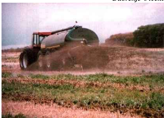
Rasturanje tečnih đubriva po površini i inkorporacija u zemljište tanjiranjem
