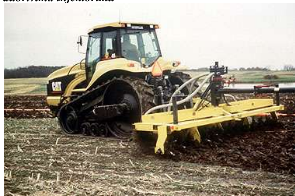
Rasturanje tečnih đubriva po površini i inkorporacija u zemljište tanjiranjem
