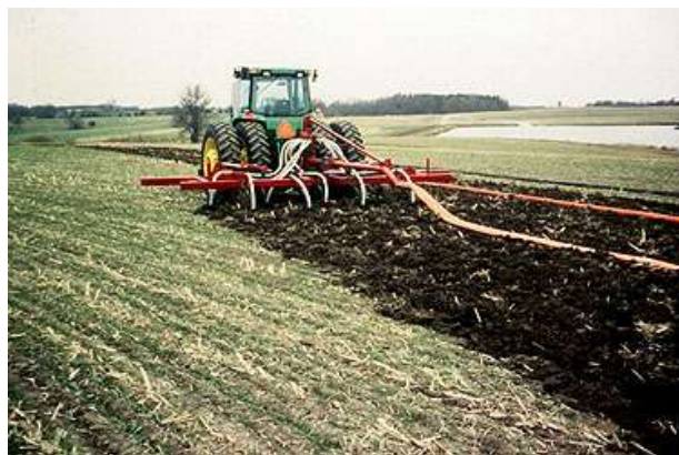
Đubrenje s tečnim đubrivima injektorima
